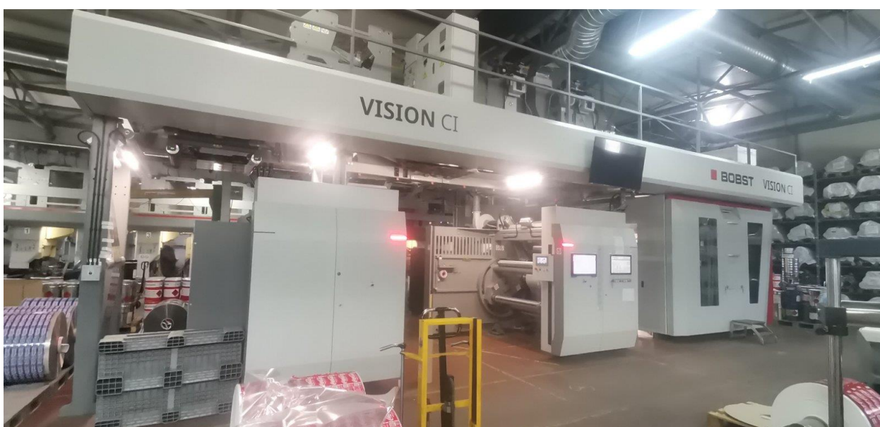
Слика 7 – Флексо машините за печатење во осум бои
