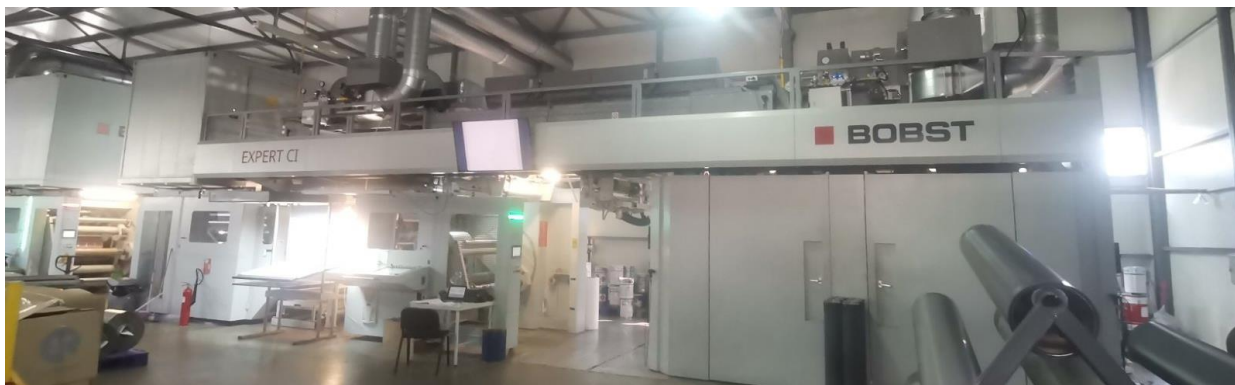
Слика 6 – Флексо машините за печатење во осум бои
