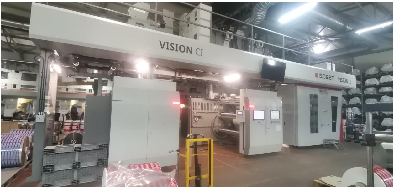
Слика 7 – Флексо машините за печатење во осум бои
